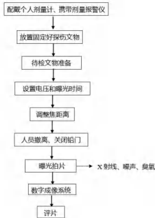
图 2-4 X 射线探伤数字成像系统工艺流程及产污位置图
